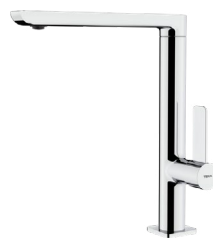
629150200 FO 915 849zł Bateria z obrotową wylewką Ruchoma wylewka obracalna o 360°, głowica z zaworem ceramicznym, elastyczne przyłącza w oplocie stalowym, otwór na baterię: 35 mm, wysokość: 271/290 mm, wysięg: 193 mm, wykonanie: chrom
